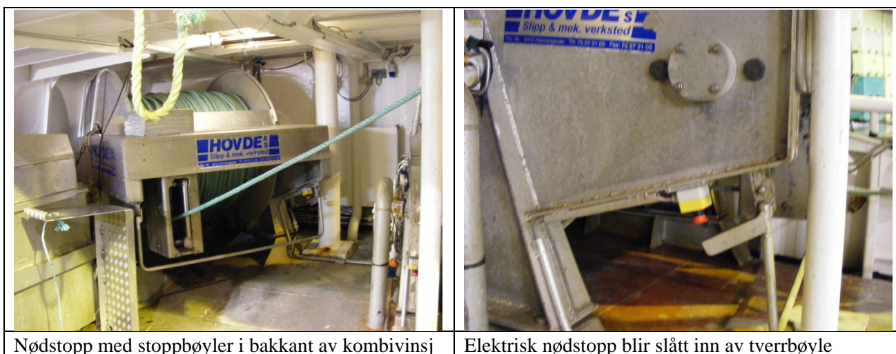
Bilde 5 Nødstopp med el-stopp og bøyle montert i bakkant av kombinasjonsvinsj for snurrevad/not.
